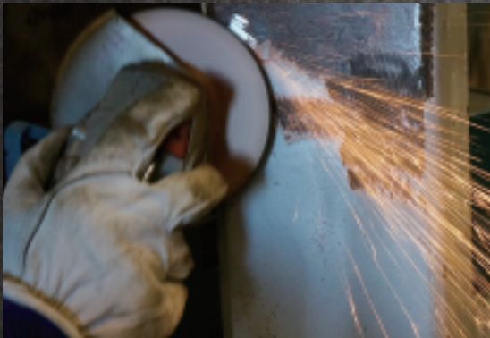
일반 그라인딩 디스크는 작업시 고온 및 다량의 스파크가 발생하여 방폭용으로 사용 부적합
