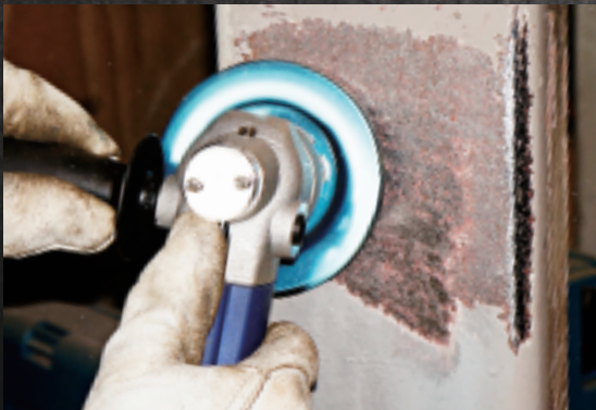
RUST ATEX 그라인더는 냉간 표면처리로 방폭 작업이 가능
